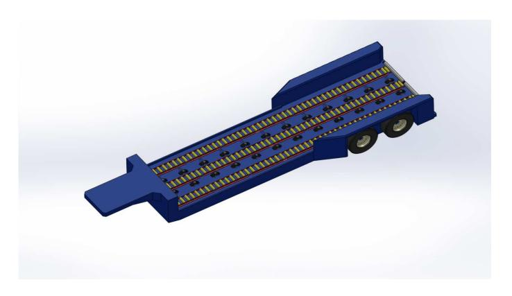
La semi-remorque SR 3P 21T, est spécialement étudiée afin de réaliser les opérations de transfert de fret conditionné en palettes ou conteneurs avion entre les différentes zones de stockage et les aéronefs.
